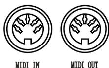
Les sorties MIDI sont à connecter sur un ordinateur ou un extenseur externe afin d'utiliser des banques de sons extérieures ou encore des logiciels dédiés.
